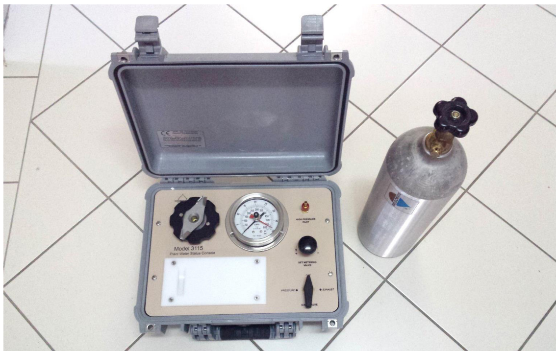
Slika 2. Tlačna prenosiva konzola za mjerenje vodnog potencijala u listovima
