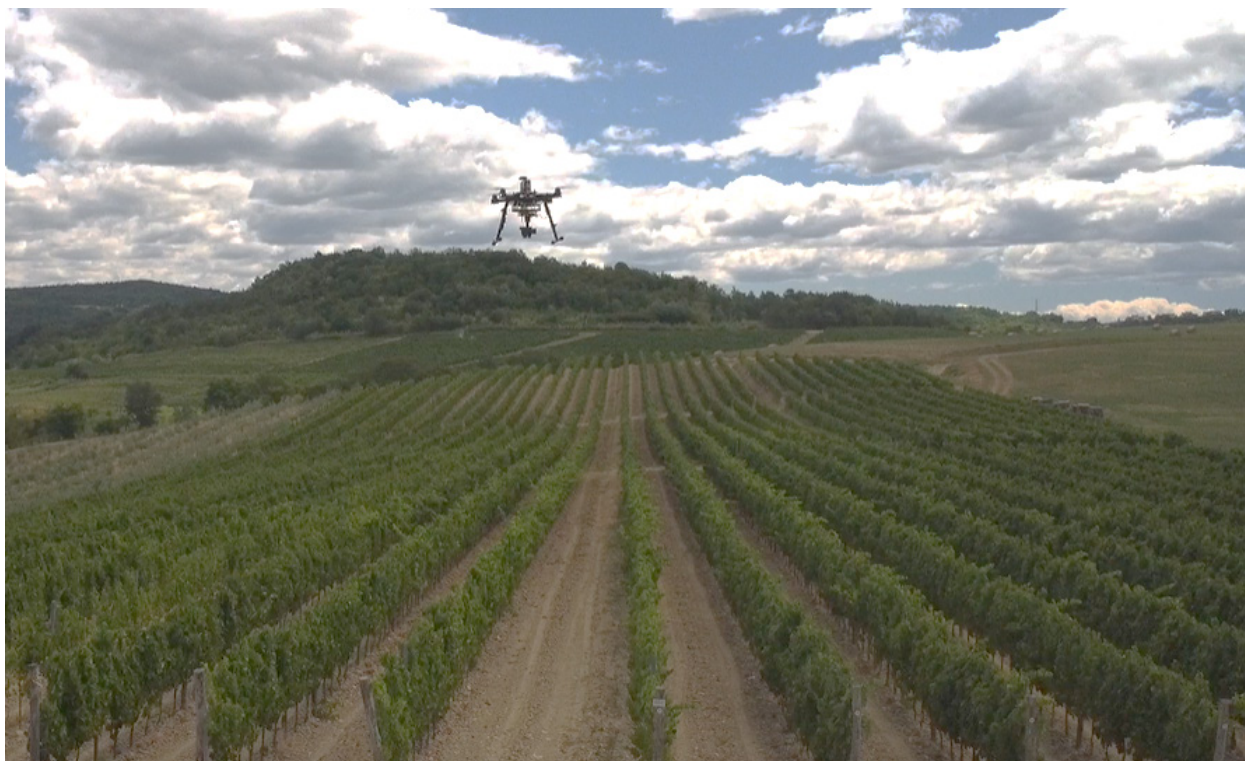
Slika 9. Multirotorska bespilotna letjelica s multispektralnom kamerom iznad vinograda.
