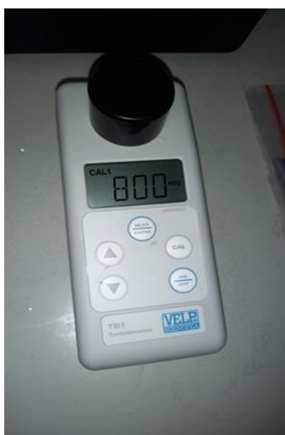
Slika 5. Uređaj za određivanje mutnoće vode – turbidimetar.
